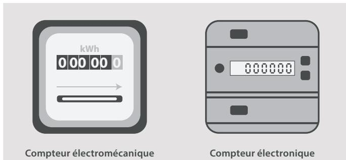
**Le compteur électromécanique** est un compteur doté d'un ou plusieurs cadrans chiffrés qui tournent grâce à la rotation d'un disque métallique.
